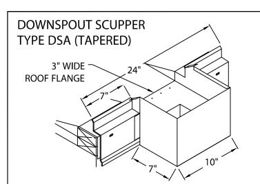
FOR USE WITH TAPERED EDGE STRIP. FLANGE LOWERED 1 1/2".
