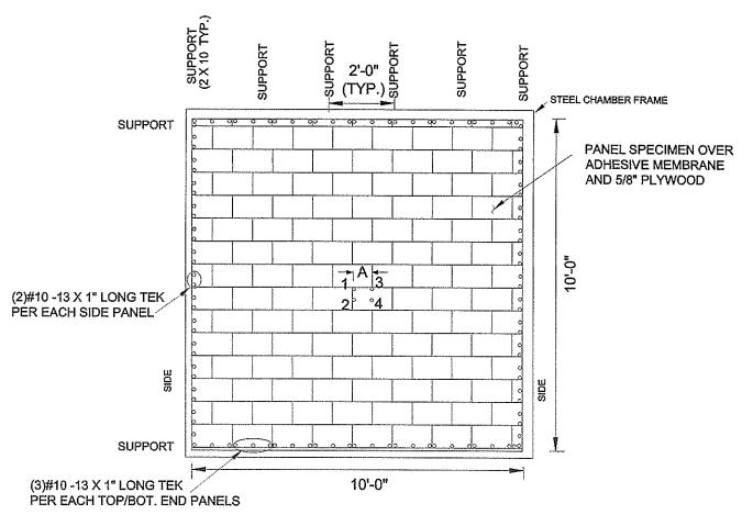
NOTE: DEFLECTION POINT #1 AT FASTENER LOCATION A= FASTENER LOCATION / 2
